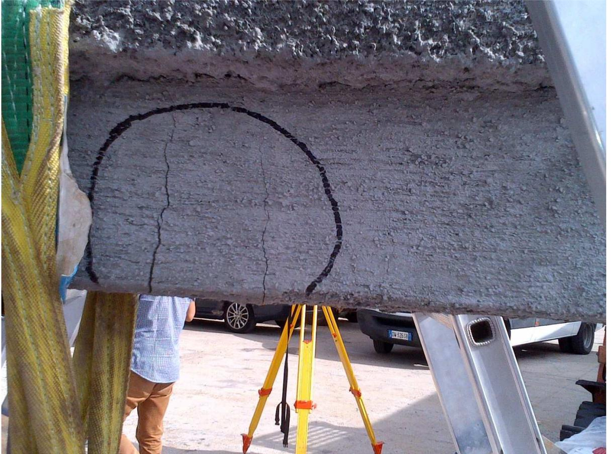
**TAV. 5 - PROVA DI CARICO TRAVETTO RINFORZATO CON TRALICCIO ELETTRISALDATO E MALTA DA RESTAURO STRUTTURALE**
