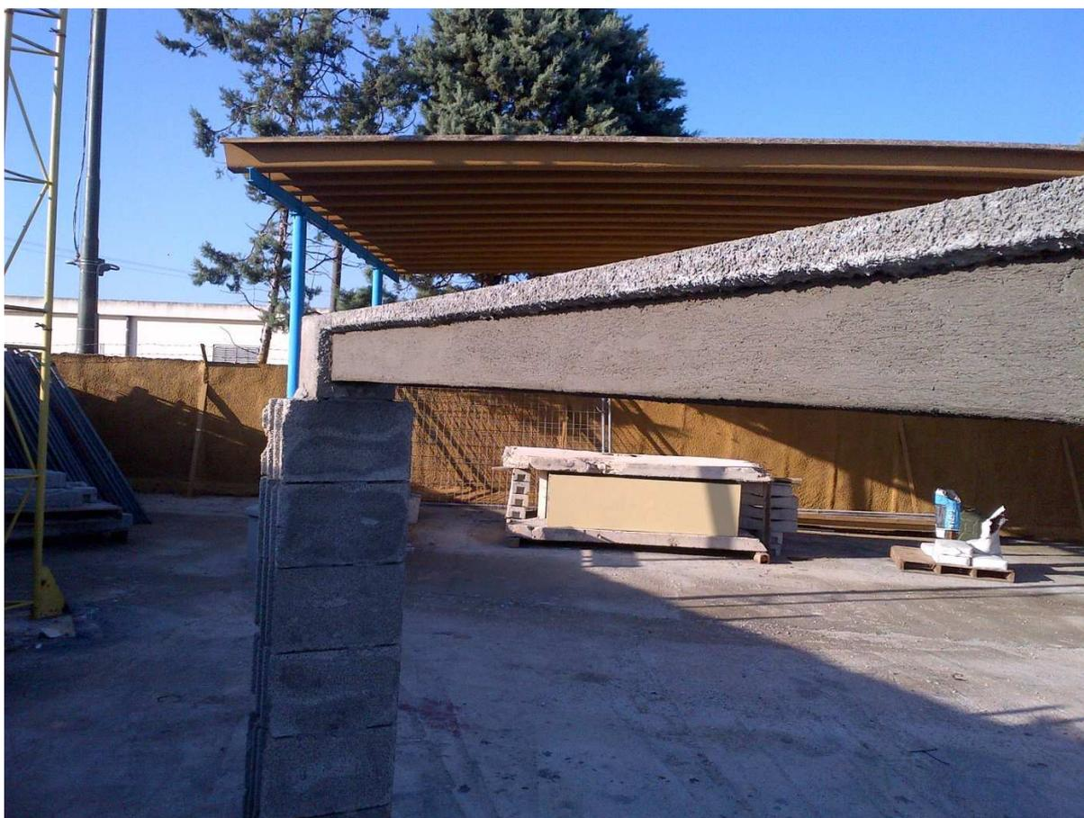
**TAV. 2 - PROVA DI CARICO TRAVETTO RINFORZATO CON TRALICCIO ELETTRISALDATO E MALTA DA RESTAURO STRUTTURALE**
