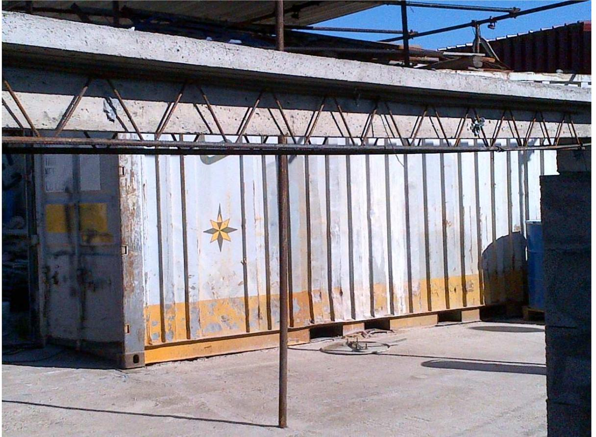
**TAV. 1 - PROVA DI CARICO TRAVETTO RINFORZATO CON TRALICCIO ELETTROSALDATO E MALTA DA RESTAURO STRUTTURALE**
