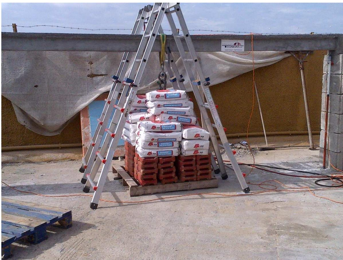
**TAV. 4 - PROVA DI CARICO TRAVETTO RINFORZATO CON TRALICCIO
