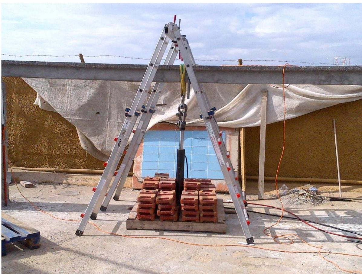
**TAV. 3 - PROVA DI CARICO TRAVETTO RINFORZATO CON TRALICCIO
